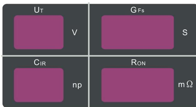
设定参数有：开启电压  $U_t$ ，跨导  $G_{fs}$ ，通态电阻  $R_{on}$  和栅漏极极间电容  $C_{irr}$  的最小和最大测量范围。
