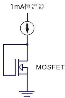
工业应用中，常常将漏栅短路条件下  $I_d=1\text{mA}$  的栅极电压定义为开启电压。
