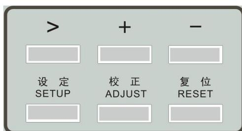
设定键 (SETUP)，移位键 (>)，加键 (+) 和减键 (-)。
