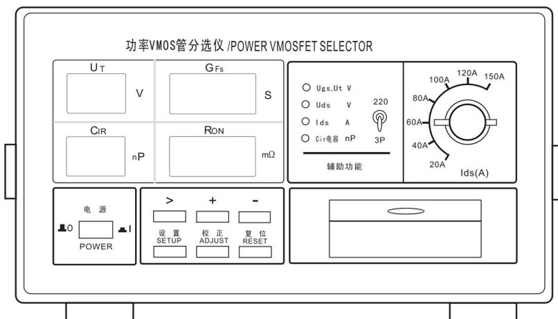
2、对测试的 Vmos 管的通态电阻  $R_{on}$ ，开启电压  $U_t$ ，跨导  $G_{fs}$ ，极间电容  $C_{ir}$  可以进行超极限判断，不符合设定要求的发出报警声，
